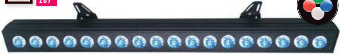
1 L'ULTRA BAR 320 LED est équipée de 320 Leds RGB de 10 mm (128 rouges, 96 vertes, 96 bleues). L'un des grands avantages de cette barre est qu'elle est divisée en 8 sections, ce qui pour vous permet de créer de beaux flows et poursuites. Elle dispose de plusieurs modes DMX pour un contrôle optimal et d'une fonction autonome réagissant au son pour les applications simples.
